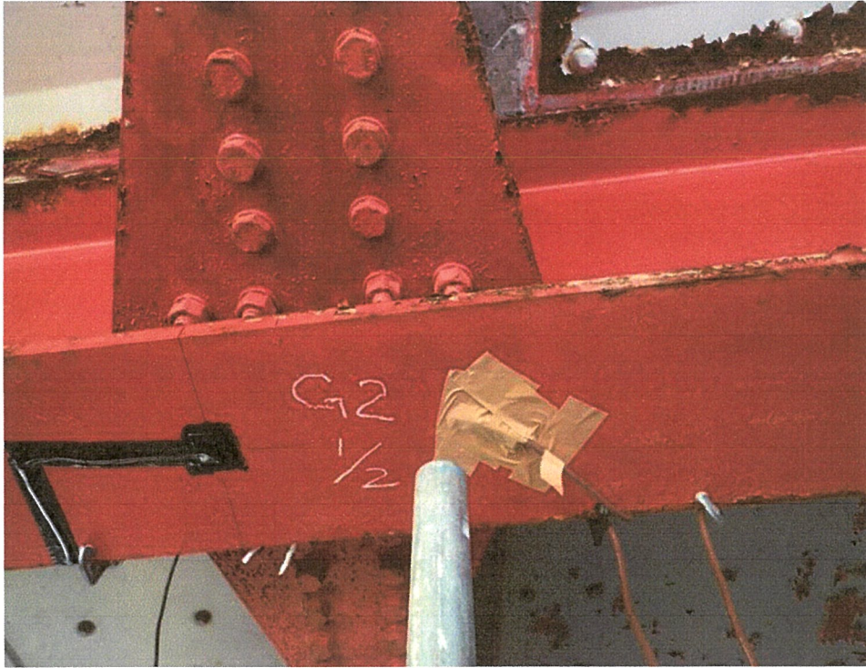
写真-3.4 熱電対による温度計測 (G2 主桁支間中央の温度計測)
