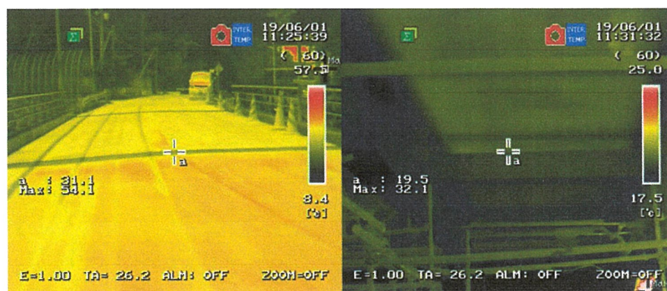
写真-付.42 床版取替後赤外線サーモグラフィー画像 (左：舗装表面，右：床版下面及び桁，2019年6月1日11:30)
