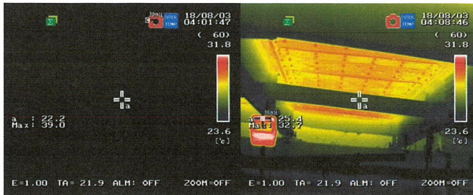
写真-付.16 床版取替前赤外線サーモグラフィ画像 (左：舗装表面，右：床版下面及び桁，2018年8月3日4:00)
