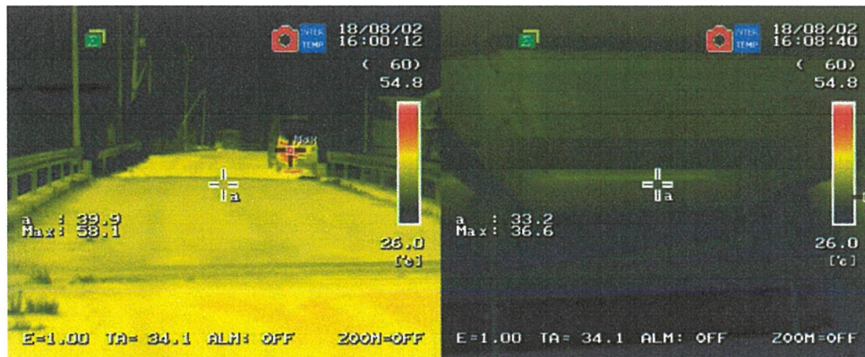
写真-付.6 床版取替前赤外線サーモグラフィー画像 (左：舗装表面，右：床版下面及び桁，2018年8月2日16:00)
