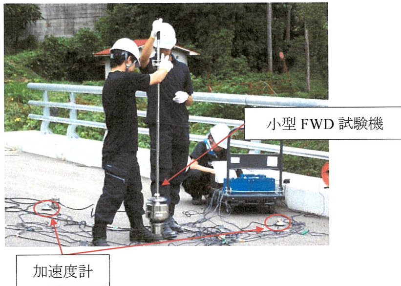
図-4.3 加速度計を用いた小型 FWD 試験実施状況
