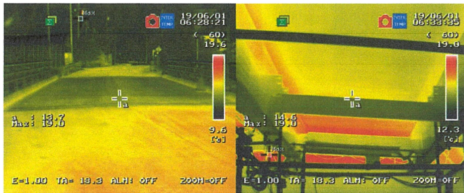
写真-付.37 床版取替後赤外線サーモグラフィー画像 (左：舗装表面，右：床版下面及び桁，2019年6月1日6:30)
