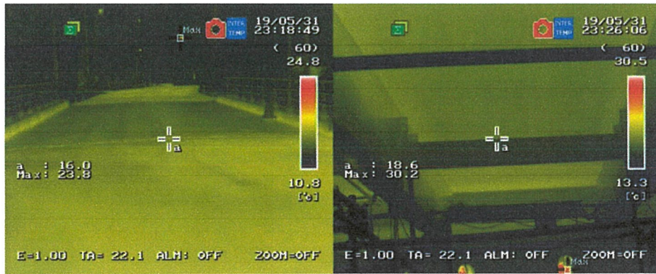
写真-付.31 床版取替後赤外線サーモグラフィー画像 (左：舗装表面，右：床版下面及び桁，2019年5月31日23:30)
