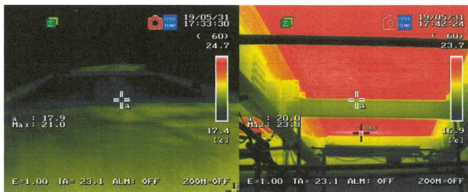
写真-付.25 床版取替後赤外線サーモグラフィー画像 (左：舗装表面，右：床版下面及び桁，2019年5月31日17:30)
