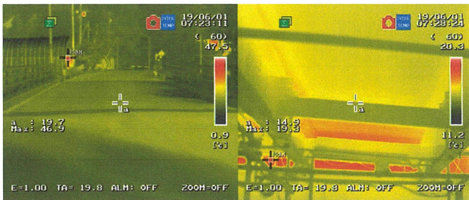
写真-付.38 床版取替後赤外線サーモグラフィー画像 (左：舗装表面，右：床版下面及び桁，2019年6月1日7:30)
