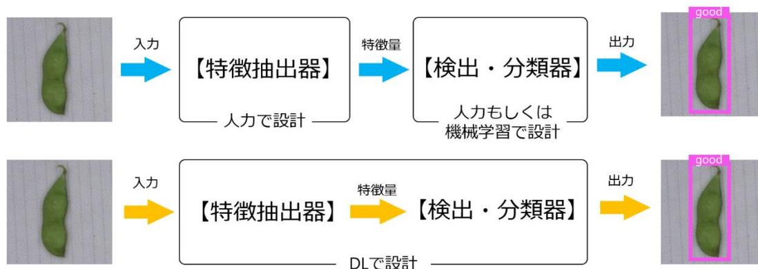
図 1-9 従来の画像処理（上段）と DL（下段）の各ネットワーク設計の違い
