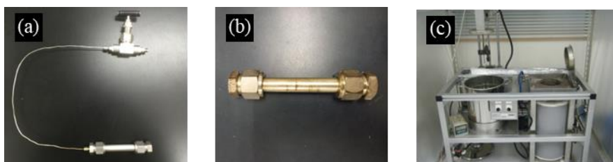
図 4-2 (a) ガス導入用金属チューブ付きステンレス製バッチ式反応器 (b) エンドキャップ型ステンレス製バッチ式反応器 (c) サンドバス (右 : 砂浴、左 : 水浴)
