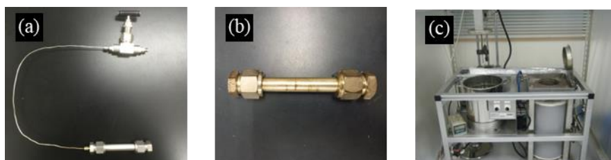
図 2-1 (a) ガス導入用金属チューブ付きステンレス製バッチ式反応器 (b) エンドキャップ型ステンレス製バッチ式反応器 (c) サンドバス（右：砂浴、左：水浴）
