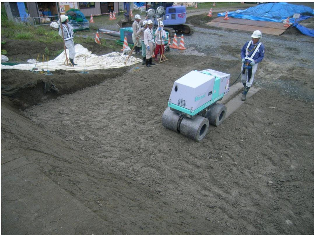
写真 5.2-4 軽石凝灰岩の転圧試験 (2010 年度)
