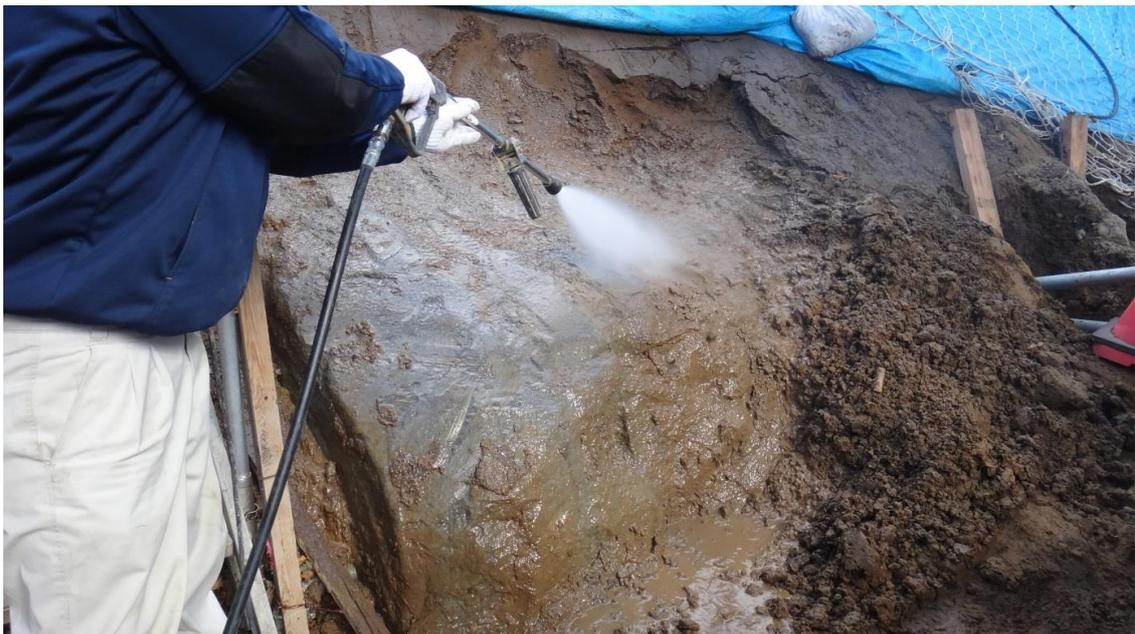
写真 5.2-6 採取前の洗浄状況（2015 年度）
