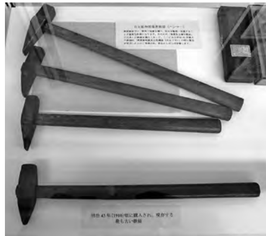
写真1 岩石用ハンマー（ピックル） 関教授の地質及土壌学教室で使用していたハンマー（鉄槌：最古は明治43年購入）が残っている。
