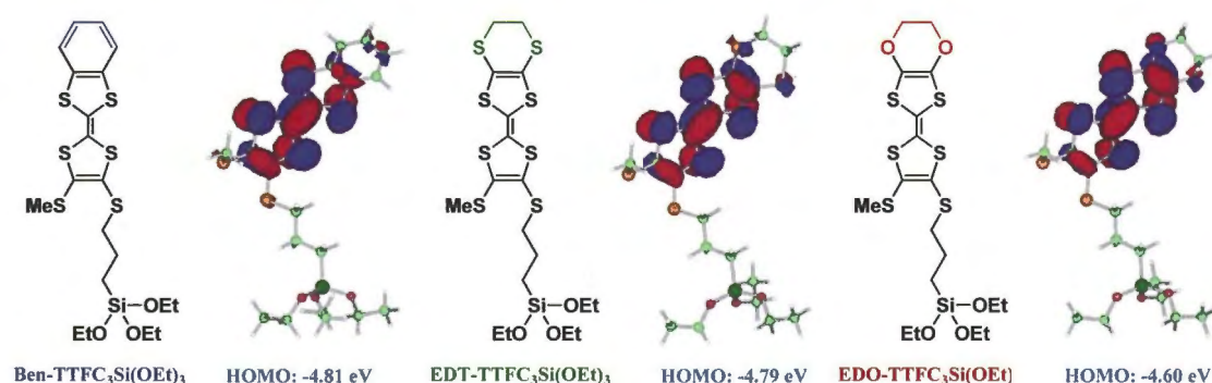
代表的な電荷移動型 SAMs 用分子の構造解析結果
