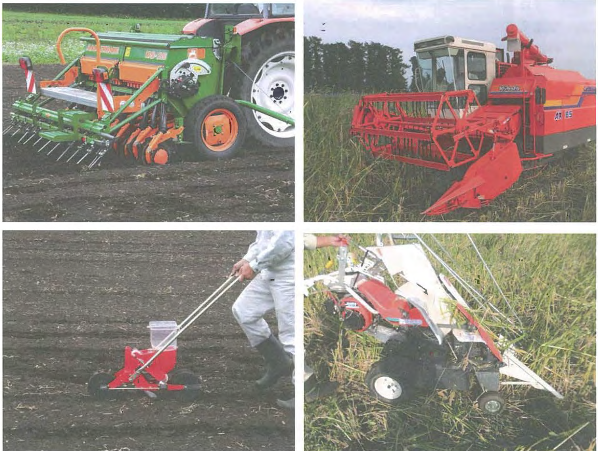
図 2. 大型機械体系（上段）と小型機械体系（下段）、播種（左）と収穫（右）
