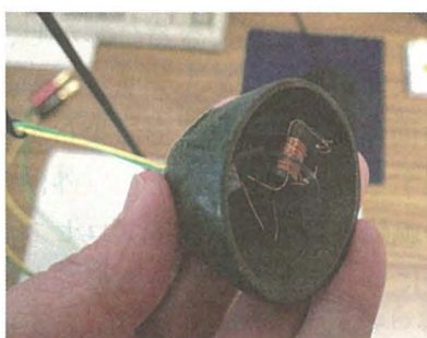
図 1 3 電磁誘導を用いた発音機構付き南部風鈴
