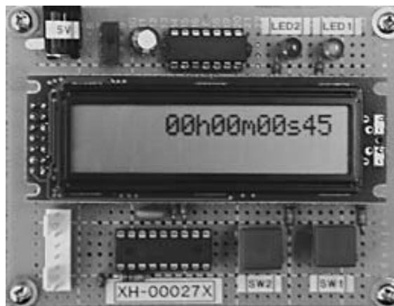
図2 マイコンコンピュータ応用実習用マイコン・システムのハードウェア Fig. 2. Hardware of micro computer system as learning tool.
