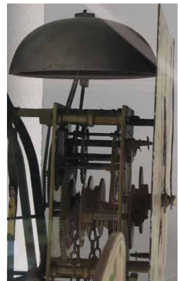
Fig. 16 イギリスのムーブメント、金属製板上に部品取付、Metal plated movement of England. (photoed June, 2007)
