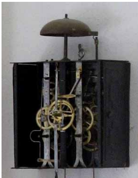
Fig. 19 棒状の鉄の枠組み上に組み立てられたコムトワーズ・クロックのムーブメント、Comtoise clock Movement, built on iron-strip frames (photoed June, 2007)
