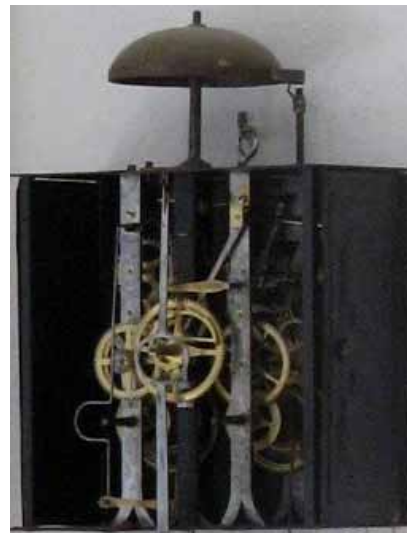
Fig. 28 コムトワーズクロックのムーブメント (前面), 重いグリディロン振り子が付く, 第4世代, Comtoise clock movement, Heavy gridiron pendulum is attached. 4th gen. (photoed June, 2007)
