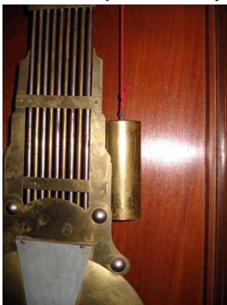
Fig. 17 資料館大時計の大きな温度補償(グリデIRON)振り子, 錘の位置は振り子の後 Heavy, Gridiron pendulum of the Hall Clock of Iwate Univ. Weight is behind the pendulum. (October, 2006)
