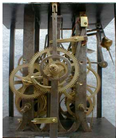
Fig. 26 コムトワーズクロックのムーブメント(前面), 第4世代, 1880-1900年頃. Front view of Comtoise clock movement, 4 th gen., circa 1880-1900
