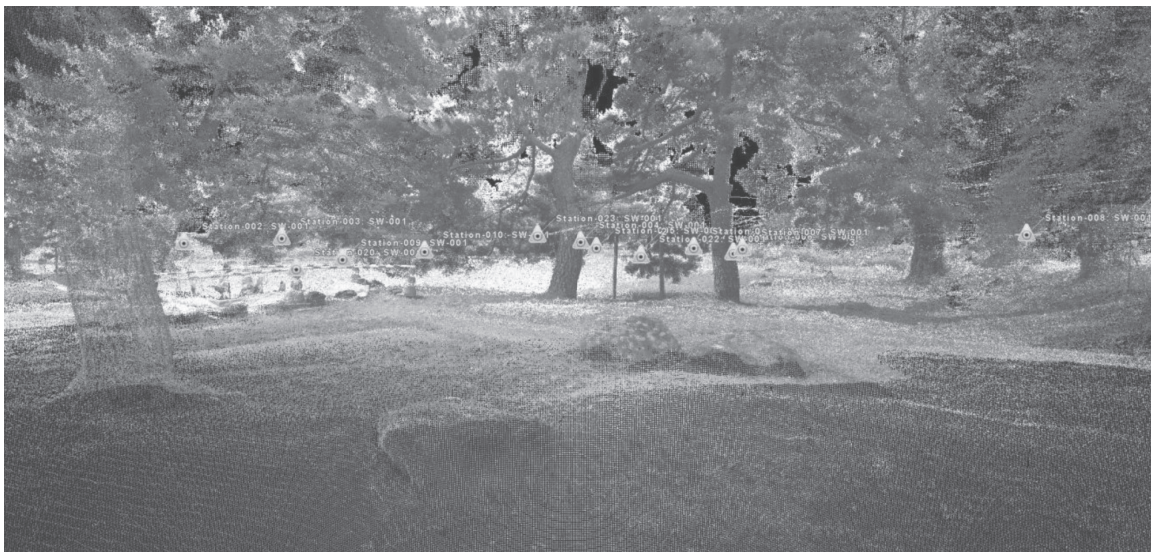
図27 無量光院跡の本堂付近の3Dレーザースキャナデータ点群(写真付加)と3Dレーザースキャナ計測ポイント▲
