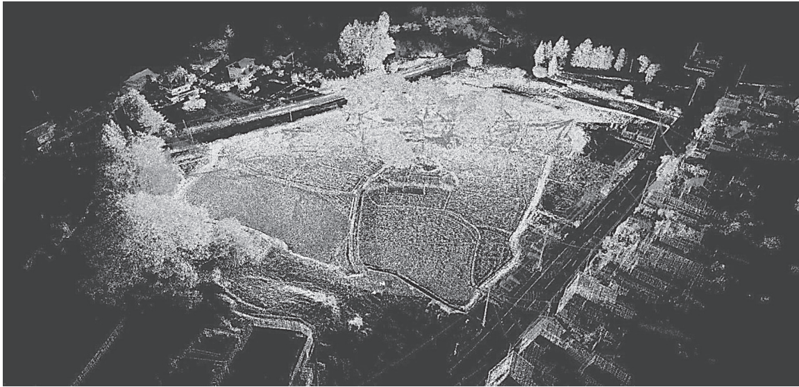
図30 クリーニング（ノイズカット）後無量光院跡の3Dレーザースキャナデータ点群 （測定箇所：計31か所 合成箇所：計29か所）
