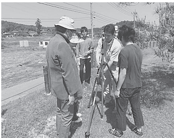
図5 ポイントターゲットの設置（2013年6月3日）
