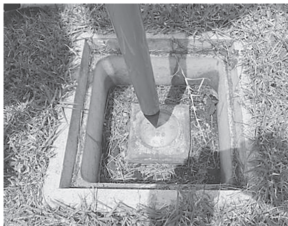
図5 ポイントターゲットの設置（2013年6月3日）
