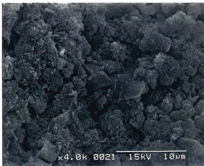
圖 2.15 走査型電子顕微鏡写真(流紋岩風化土, 4,000倍)
