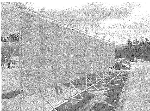
写真3 MDFロットB試験体の屋外暴露の様子（岩手県林業技術センター構内）
