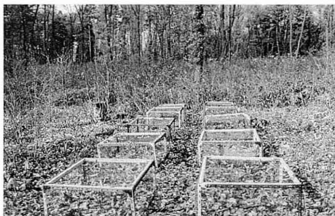
図12 鋼製枠に金網を張って出芽試験
