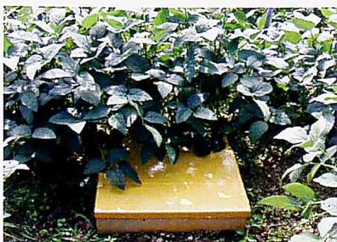
写真 II-2-5 開放ライシメータの設置の状況（ベントナイト使用）（2004/6/14 撮影）
