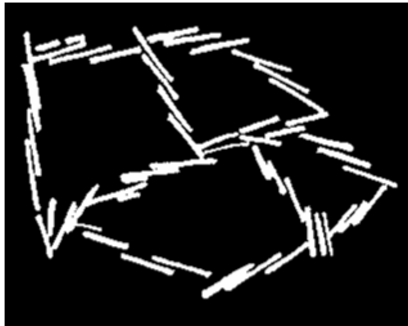
Fig.5-18 凝集カオリナイトの階段状カードハウス構造(O'brien)
