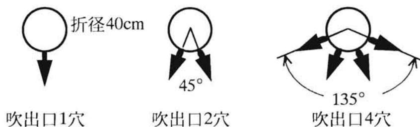
換気用ポリダクト半径方向断面図
