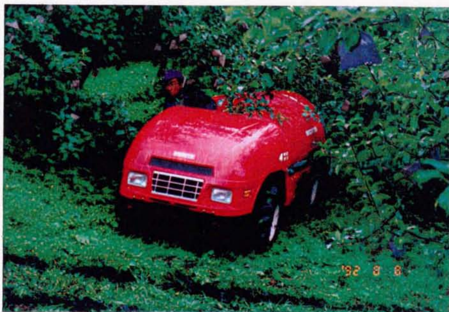
りんご樹の枝がSSの走行に支障をきたす (平賀町新屋) 写真-5
