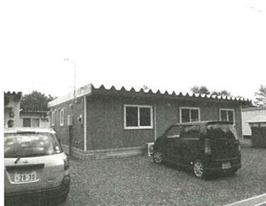
写真7/宮古市内・荷竹地区の仮設住宅団地に建設された仮設集会施設。外壁には塗装した「復興ボード」があらわして使用されており、独特の存在感を示している。
