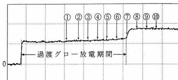
(b) 放電電流波形, 縦 3.74A/div; 横 1.0  $\mu$ s/div.
